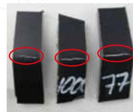
Abbildung 4: Frontalansicht der drei „Originalhersteller“ Proben nach Biegeprüfung. Risse an allen Proben erkennbar.
