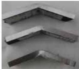
Abbildung 1: Seitenansicht der drei „GRANIT“ Proben nach Biegeprüfung. Keine Risse erkennbar.
