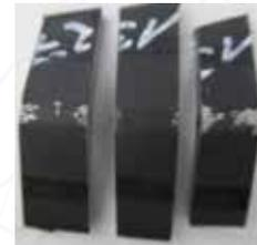
Abbildung 2: Frontalansicht der drei „GRANIT“ Proben nach Biegeprüfung. Keine Risse erkennbar.
